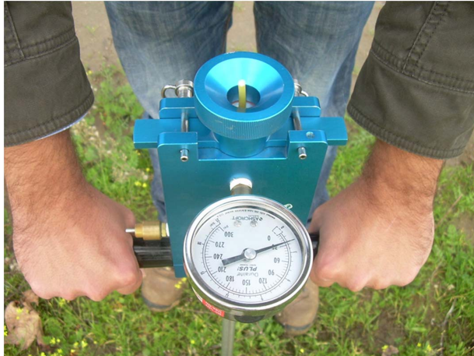
Câmara de pressão utilizada para monitorizar o potencial hídrico foliar de base. Modelo Pump-Up Pressure Chamber da PMS Instrument Company.
